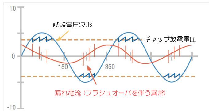
図2：フラッシュオーバが発生した漏れ電流波形
