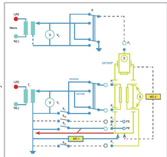
参照 : UL 60601-1 図. 18 測定回路 外装漏れ電流用
