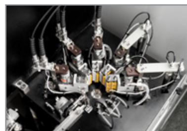
5個同時試験が可能な専用治具 (同時試験は試験器の台数による)
