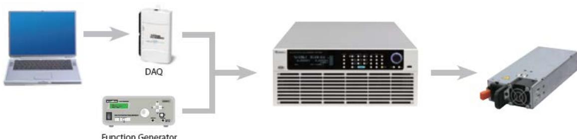
実際の電流プロファイルと波形をシミュレーションするため、ユーザー定義波形（UDW）に対応した拡張機能を有しています。実際の電流波形を再構築するために、ユーザーはソフトパネル（オプション）を介して、取得した波形データをアップロードすることができます。より厳しい試験要求に対応するため、最大150万のデータポイントからなる10セットまでの波形を保存することができます。
