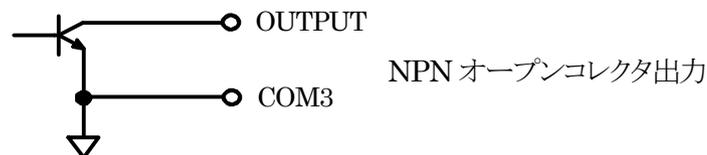
オープンコレクタ定格  $V_{CE} = DC35 V_{max.}$ 、 $I_e = DC100 mA_{max.}$
