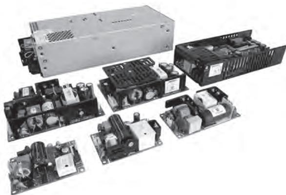
CME-Aシリーズは、基板型(30/60/100/150/200W)・ユニット型(350/1500W)のAC-DC電源です。30~350W出力モデルは自然空冷方式、1500W出力モデルはファン可変速回路を搭載した強制空冷方式を採用しており、静音化が求められる各種装置に最適な電源です。
