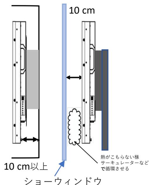
ディスプレイ使用時の周辺温度は 0~40 度の範囲に保って頂く必要があります。温度が仕様上限の 45°C を超えますと、輝度を低下させて熱の発生を落とし故障や事故を防ぐ安全機能
