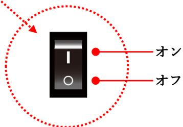
注：リモコンは電源スイッチが、オンの場合のみ作動します。リモコンでディスプレイを稼働させる際、画が出るまで5～6秒かかります
