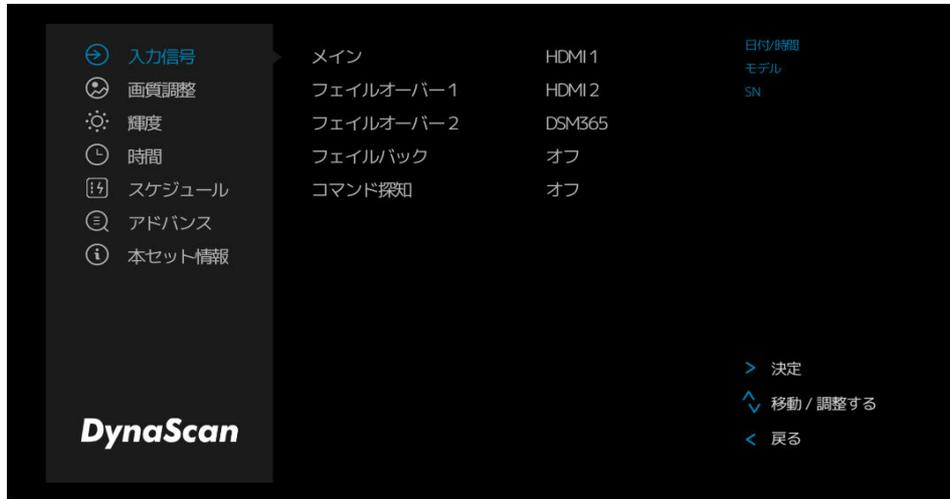
\*フェイルオーバーとは優先している入力信号が何等かの理由で途絶えた場合にバックアップとして次の信号を再生する為の設定。左の場合はHDMI1信号がメイン、もし信号が止まったらHDMI2—DSM365 (内蔵メディアプレイヤー)の順で入力のある信号を再生。使用しない場合はオフを選択してください。
