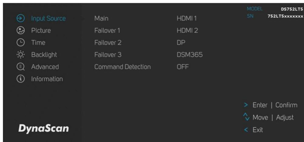
\* Failover とは優先している入力信号が何等かの理由で途絶えた場合にバックアップとして次の信号を再生する為の設定。左の場合は HDMI1 信号がメイン、もし信号がなくなったら HDMI2—DP—DSM365(内蔵メディアプレイヤー)の順で入力のある信号を再生。
