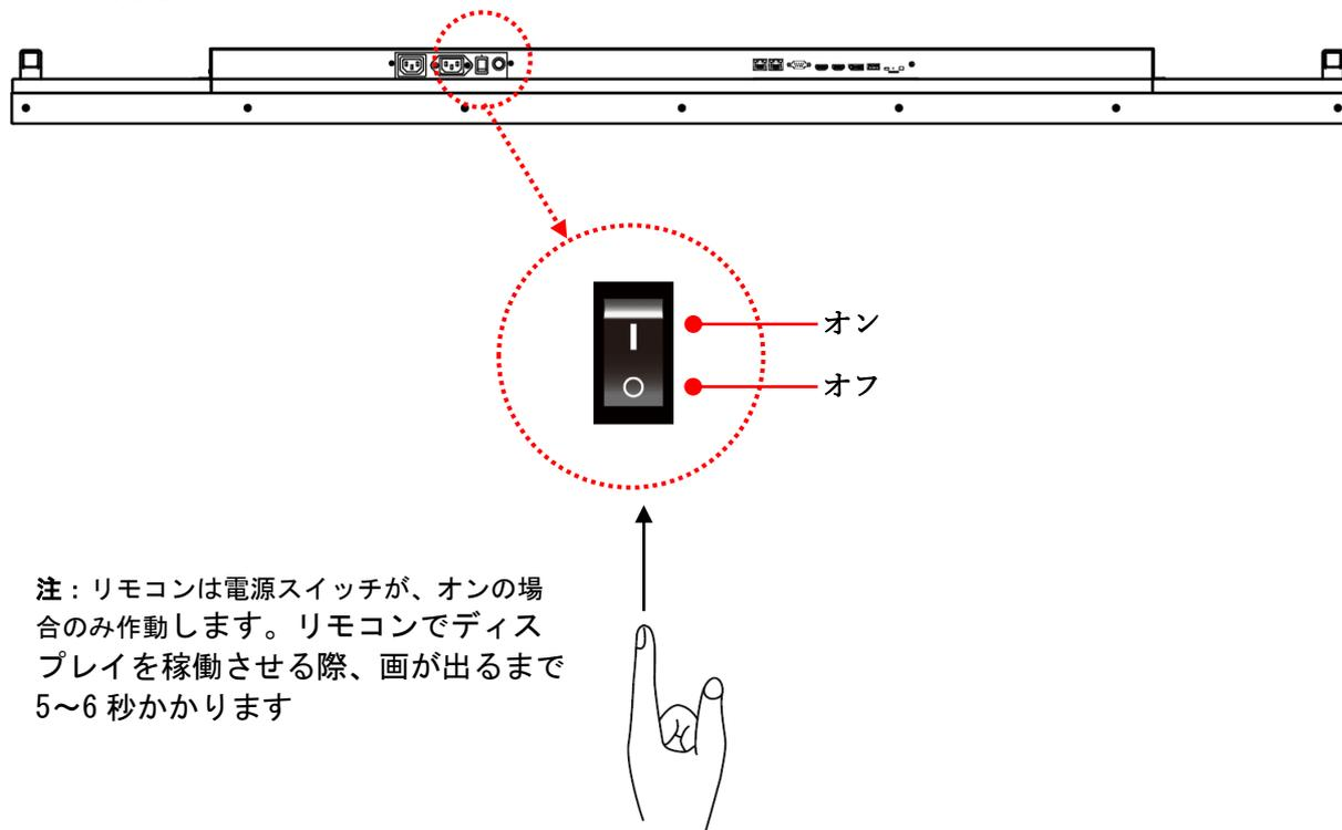
注：リモコンは電源スイッチが、オンの場合のみ作動します。リモコンでディスプレイを稼働させる際、画が出るまで5~6秒かかります
