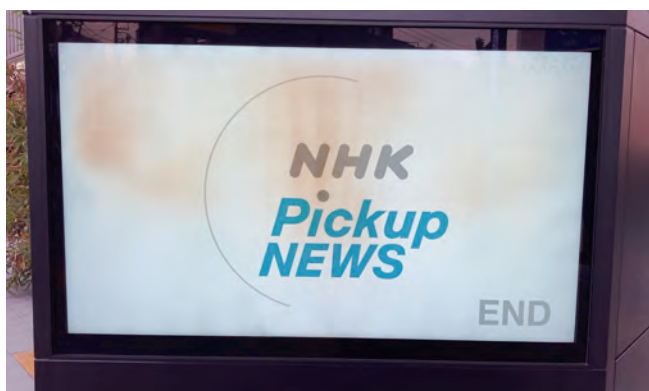
ベンチレーションが無い密閉の筐体で太陽光の強い屋外で使用され液晶と光学シートが劣化して茶色のムラが発生した例
